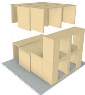
CLTパネルによる木造ユニットの概念図
