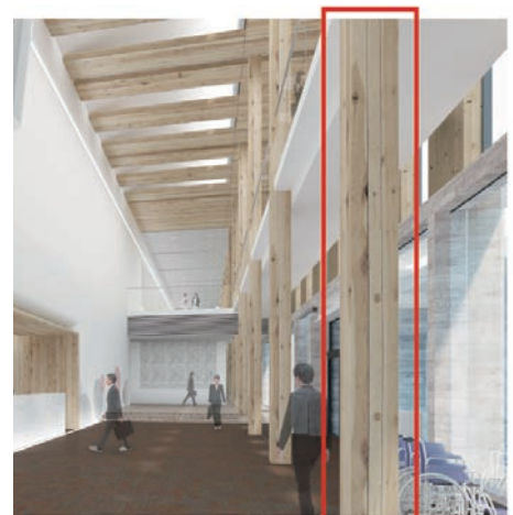
スギ材による鉄骨柱の防火被覆
