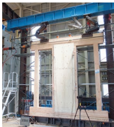
S.S.W.14 工法を拡張した高耐力壁 試験体での実験の様子
