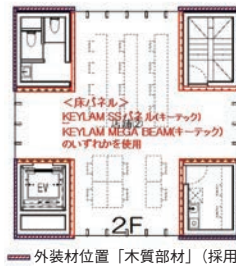
■ 外装材位置「木質部材」（採用部材は検討中） ■ 内装材位置「CLT材（60mm）」（間仕切り壁） ■ 内装材位置「CLT材（36mm）」
