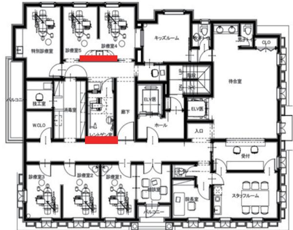
2階平面図（ミッドプライウォール配置 ■部分）
