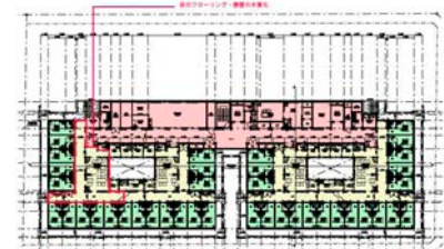
内装の木質化の範囲(4、5階のショートステイのユニットの共同生活室部分)
