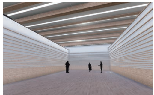
木質ハイブリッド集成材の柱・梁、県産材による内装があらわになった内観パース
