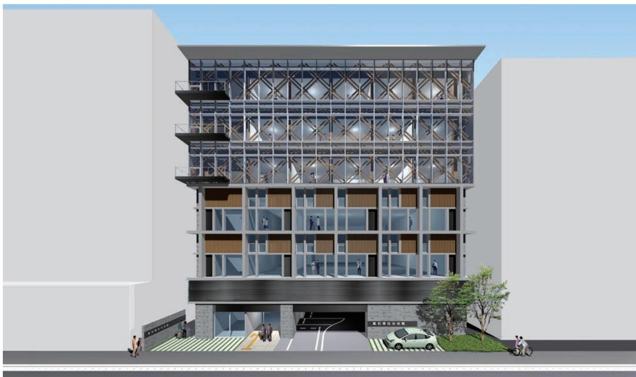
正面北側の外観パース。4 階から上が耐火木造で造られ、外部からもブレースの木組み構造が見える
