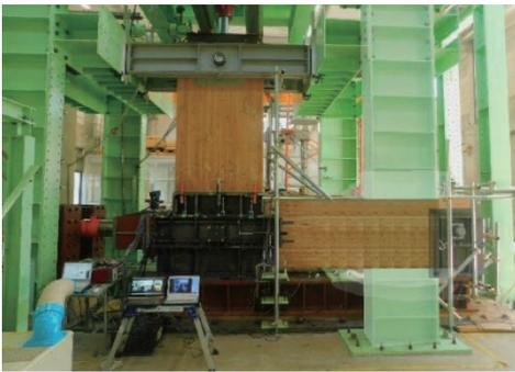
柱・梁L字型架構の実物大試験の様子
