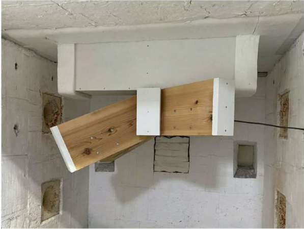
試験体 1 燃焼実験前
