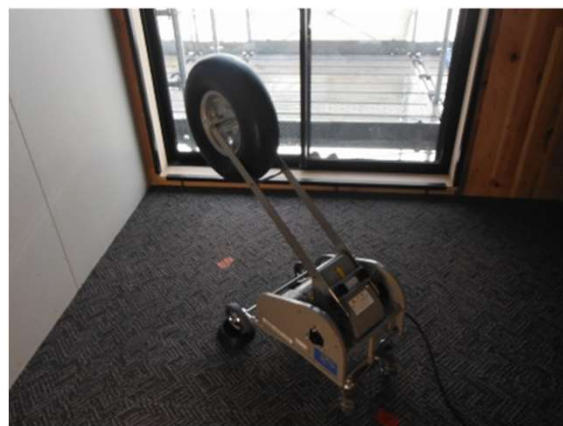
遮音測定状況
