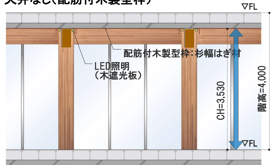
天井なし(配筋付木製型枠)
