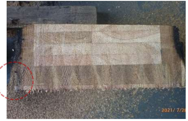
燃焼後 耐火集成材切断面
