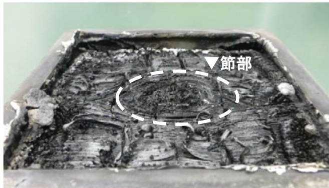
難燃処理ラミナ節部燃焼実験
