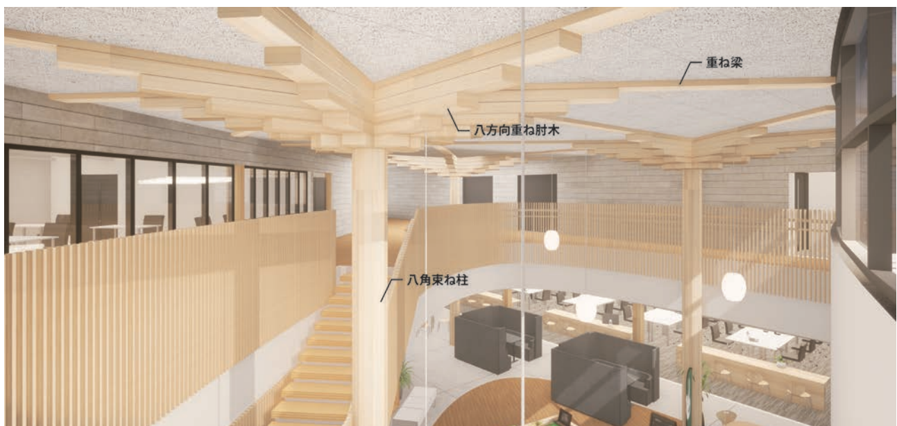
ヨリアイホールの内観パース 大黒柱のような束ね柱（八角柱）と八方向重ね肘木
