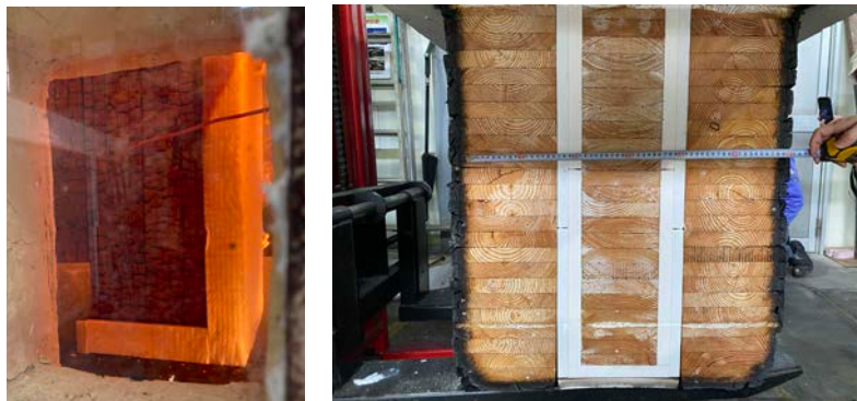
耐火試験状況 左：加熱状況 右：燃え残り部分
