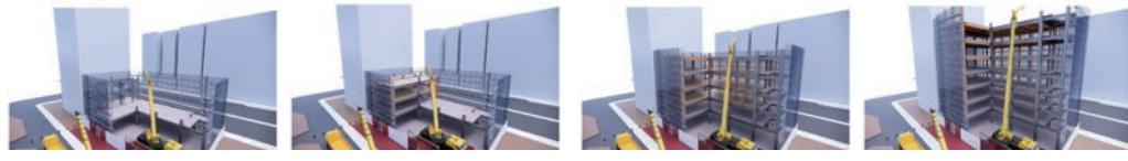
BIM活用による施工手順シミュレーション
