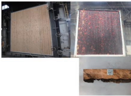
壁柱（耐力壁）の耐火試験状況
