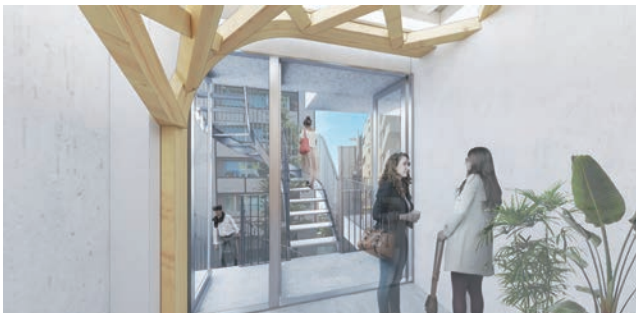
低層階の木耐震方杖（3階オフィス内観）
