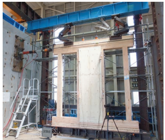
S.S.W.14 工法を拡張した高耐力壁 試験体での実験の様子
