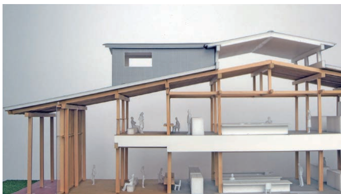
木あわしの架構が連続する開放感のある内部空間
