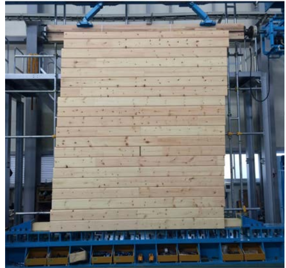
厚物壁板工法の実大実験の様子
