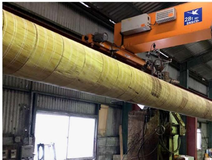
円筒状のLVLは、先行して製作した柱に帯状のLVLを何層にも巻き重ねて製造している。
