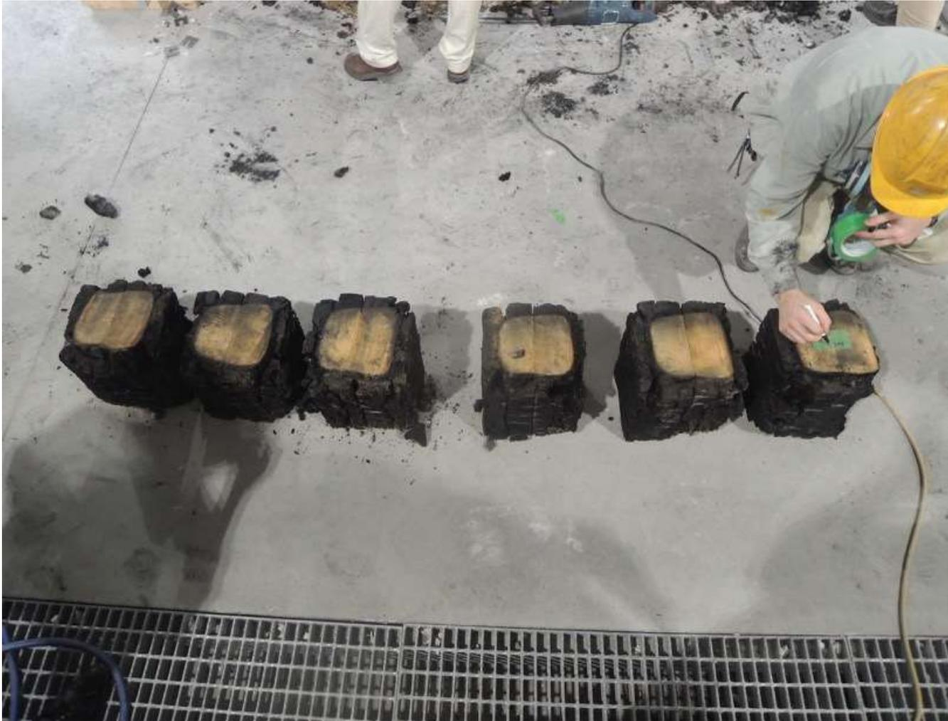
燃焼後の柱断面
