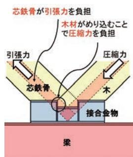
耐震システムの応力処理機構
