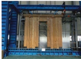
採用モデル（鋼板挿入型ドリフトピン接合）
