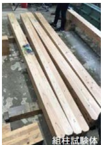
組立柱の座屈試験の様子
