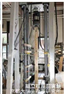
組立柱の座屈試験の様子
