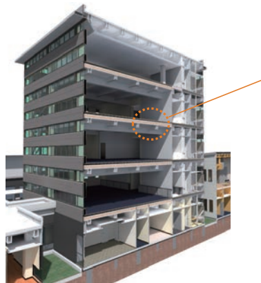
6階建て以上の建物で2時間耐火となる床構造は国内初
