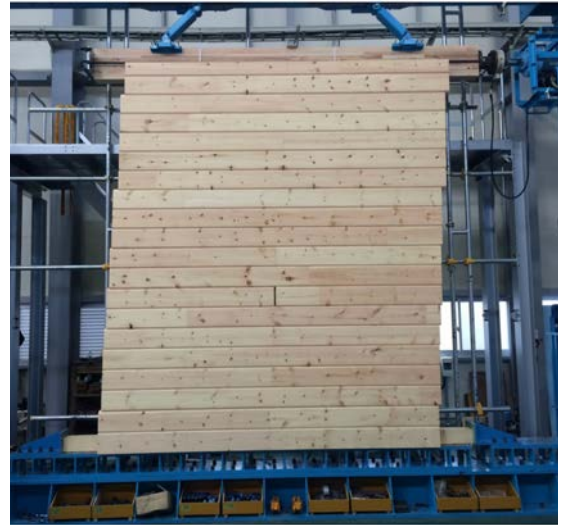
厚物壁板工法の実大実験の様子
