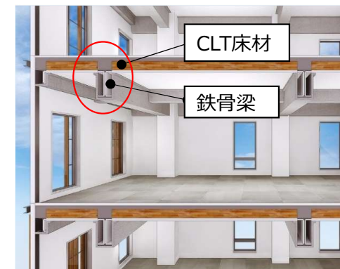
▲CLT床断面イメージ
