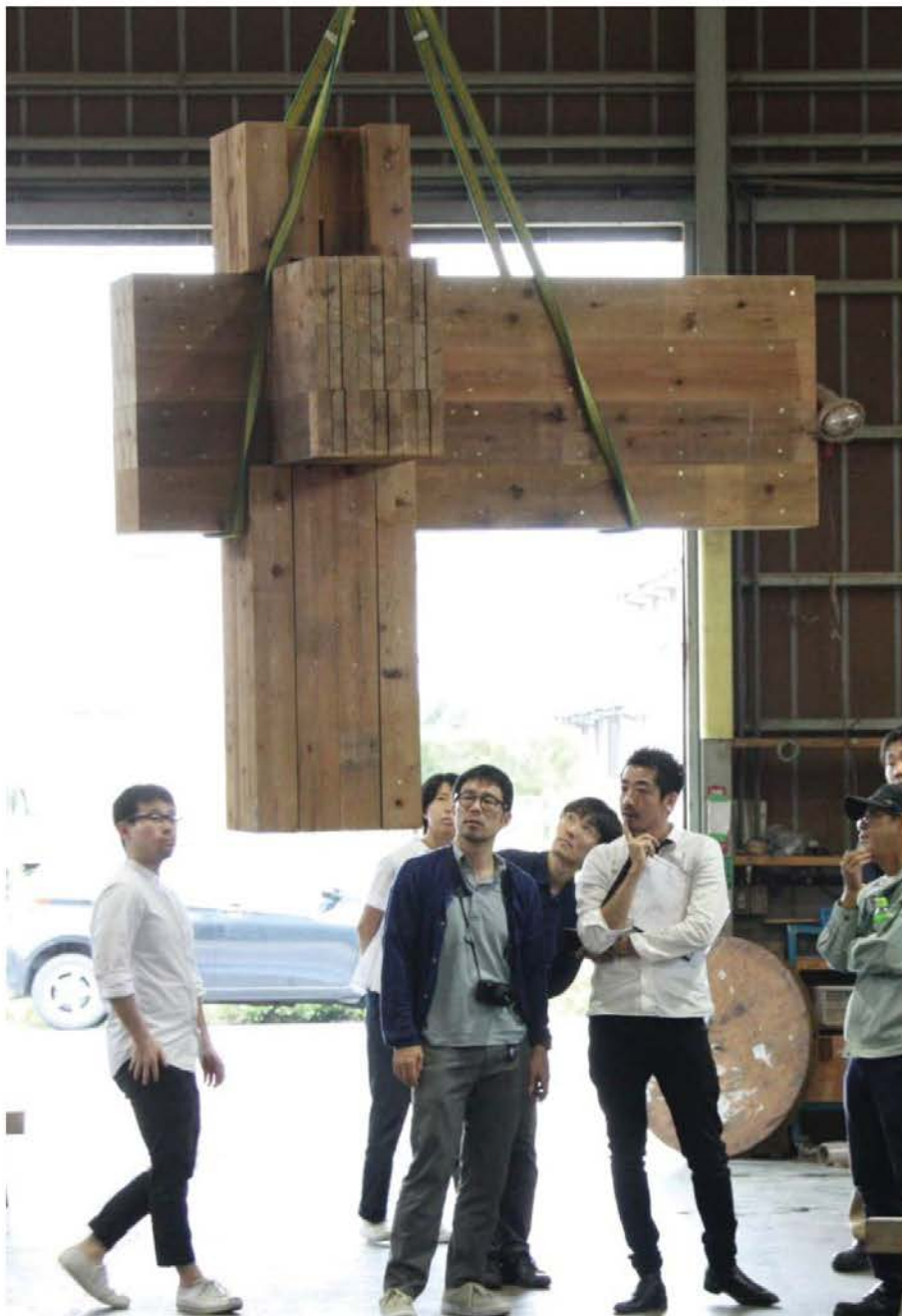
前例のない柱と梁の構成のため、初期段階より木加工メーカーと検討を重ね、試作を行った。
