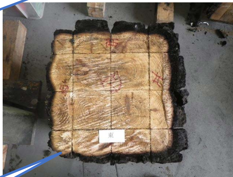
束ね柱試験体の残存断面
