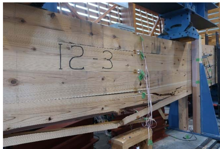
図 14 IS-2 中央部曲げ破壊
