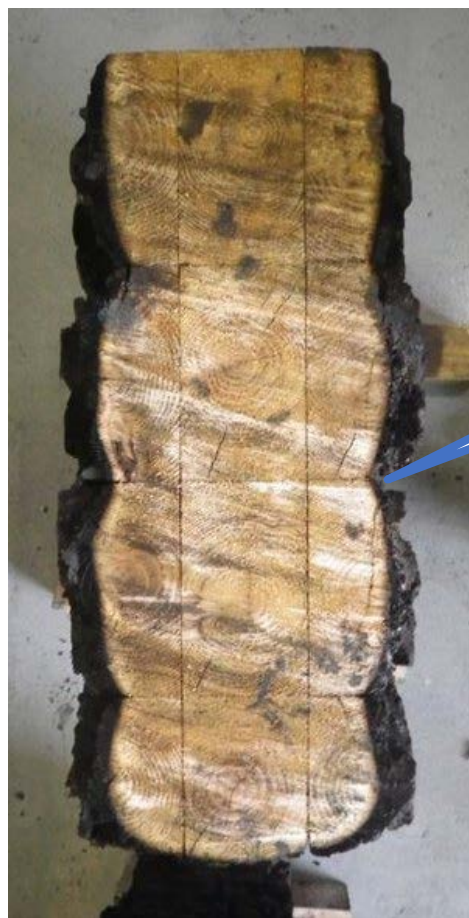
重ね梁試験体の残存断面
