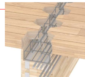
CLT屋根ブレースとSAMURAIの接合部
