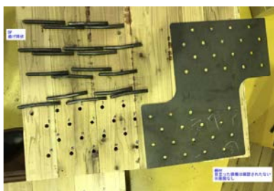
銅板・ドリフトピン試験状況
