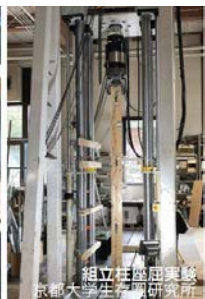
組立柱の座屈試験の様子
