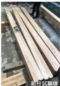
組立柱の座屈試験の様子
