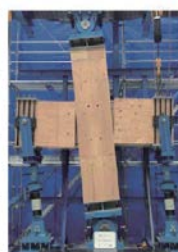
金物を使わない剛接仕口ユニット試験結果
