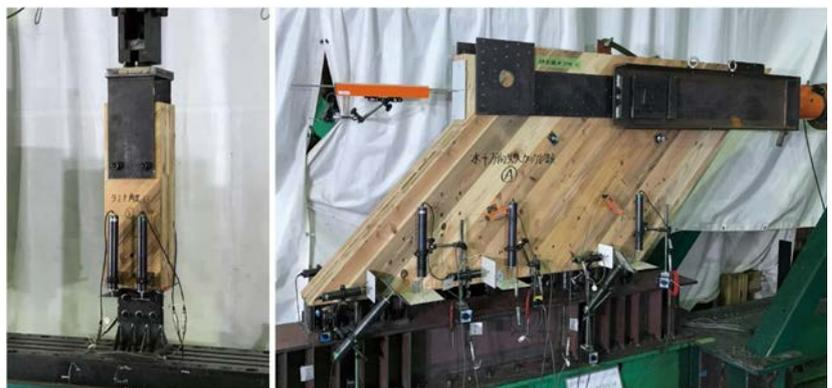
CLT パネル接合部の性能評価試験状況
