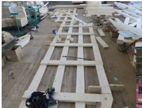
2×4規格材による工場でのフレーム製作
