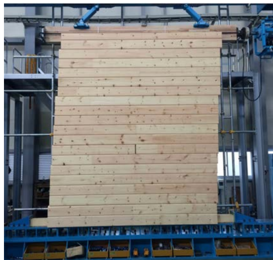
厚物壁板工法の実大実験の様子
